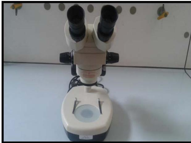
**Photo 9 :** Stéréoscope utilisé pour l'identification des vers de terre.
